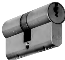
526 Profil-Doppelzylinder, beidseitig schließbar, 61 mm, 5 Stiftzuhaltungen je Seite
