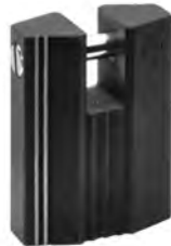
9249 Zylinder-Vorhangschloss 2, 6+3 Stifzuhaltungen 8 mm Stange, mit Schließzwang, mit Bohrschutz
