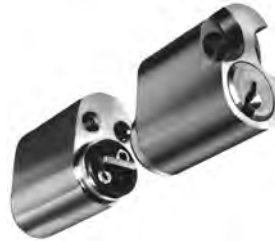
6502 Oval-Doppelzylinder, 6+5 Stiftzuhaltungen je Seite, mit Bohrschutz, für Einsteckschlösser z.B. 560, 565...
