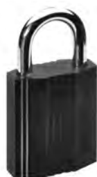
21541 Zylinder-Vorhangschloss 2, 5 Stiftzuhaltungen und 1 Flexcorenadel, 8 mm Bügel, mit Schließzwang
