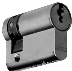
523 Profil-Halbzylinder, 30,5 mm, 5 Stiftzuhaltungen
