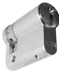
923 Profil-Halbzylinder, 30,5 mm, 6+3 Stiftzuhaltungen mit Bohrschutz
