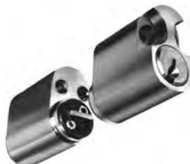
1002 Oval-Doppelzylinder, 6 Stiftzuhaltungen + 2 geteilte Seitenstifte mit Seitenschiene je Seite, mit Bohrschutz, für Einsteckschlösser z.B. 560, 565...
