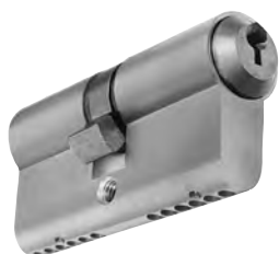
622 Profil-Doppelzylinder, 61 mm, 6 Stiftzuhaltungen je Seite, mit Bohrschutz
