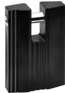
9549 Extra schweres Zylinder-Vorhangschloss 4/5, 6+3 Stifzuhaltungen 14 mm Stange, mit Schließzwang, mit Bohrschutz
