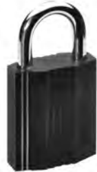
9341 Schweres Zylinder- Vorhangschloss 3, 6+3 Stifzuhaltungen 2 geteilte Seitenstifte 10 mm Bügel, mit Schließzwang, mit Bohrschutz
