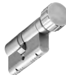
524 Profil-Knaufzylinder, 61 mm, 5 Stiftzuhaltungen einseitig, Knauf 22 mm Ø,
