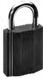
6240 Zylinder-Vorhangschloss 2, 6+5 Stiftzuhaltungen 8 mm Bügel, ohne Schließzwang, mit Bohrschutz
