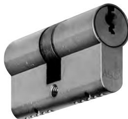
1526 Profil-Doppelzylinder, beidseitig schließbar, 61 mm, 5 Stiftzuhaltungen und 1 Flexcorenadel je Seite
