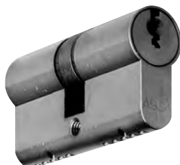
522 Profil-Doppelzylinder, 61 mm, 5 Stiftzuhaltungen je Seite
